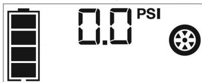
El icono del compresor se encenderá y la pantalla LCD retroiluminada mostrará alternativamente el preajustado valor psi que parpadea (el último valor introducido por los botones de control de presión del compresor) y la actual psi presión del artículo al ser inflado (que se ilumina sólido).
