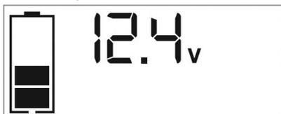
Las barras en el icono de estado de la batería representan el nivel de carga de la batería interna de la unidad. Las barras en el icono de estado de la batería cambiará de vacía a sólido (de abajo a arriba) varias veces para indicar que la unidad se está cargando. La luz de fondo se encenderá durante 10 segundos (solamente).
